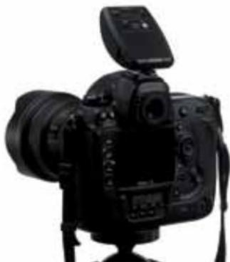
а) Задвиньте разъем "горячий башмак" [19] устройства Profoto Air в паз "горячий башмак" фотоаппарата.
