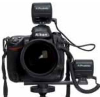
6. Включите устройство Profoto Air (передатчик) и проверьте, что горит индикатор "Transmit" [3].
