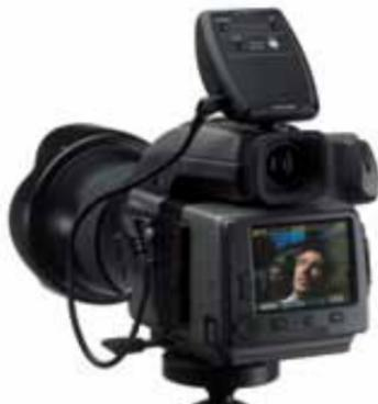
б) Подключите кабель синхронизации фотоаппарата к входному разъему (In) [16] устройства Profoto Air.
