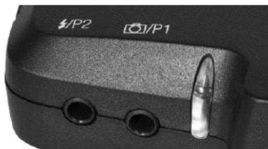
*Используйте гнездо "⚡/P2" для подключения вспышек, работающих в ручном режиме*
