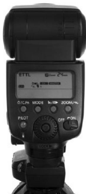
*Canon Speedlite в режиме <MASTER> на MiniTT1, установленном на горячий башмак камеры*
