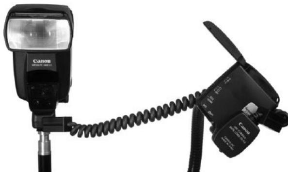
*Подключение при помощи кабеля OC-E3, обеспечивающее максимальную дальность*
